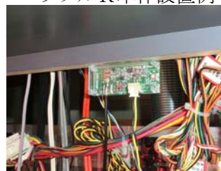
受信専用アンテナ取付例
