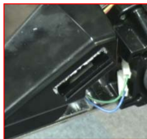
ゴト行為により破損された払出口
