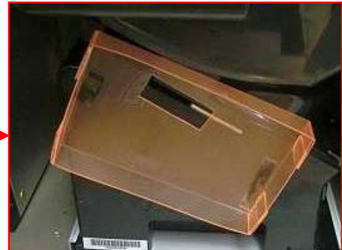
コイン払出し口から ピアノ線を侵入させた状態
