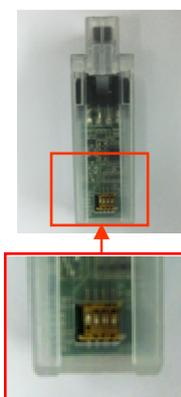
注：「パワフルS」は、サブ基板の電源ラインのショートゴトに対して検知は有効ですが、サブ基板とメイン基板の通信ラインへのショートゴトについてはカバーによる対策が必要です。
